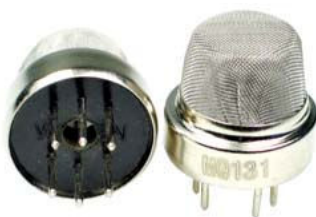
Figura 3.3: Encapsulamento do MQ-6
