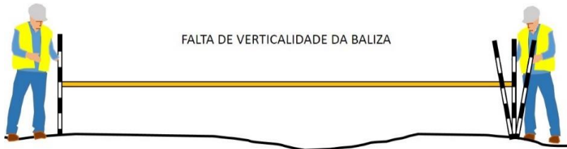
Figura 1.2.2. Erros de verticalização da baliza topográfica.
