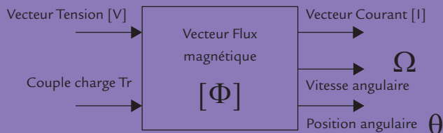
Figure 1.1 Principe de la conversion électromécanique
