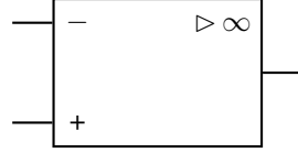
Figure 2.11 – Amplificateur opérationnel idéal.
