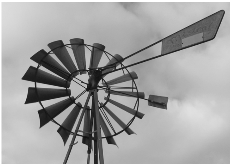
Figure 1.8 – Exemple d'effacement sur une petite éolienne Mistral en réduisant l'angle entre le gouvernail/ressort et la palette (crédit photo : M. Rapin)
