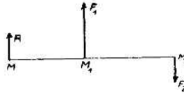
Figure 1.5 – Deux forces parallèles et de sens opposés
