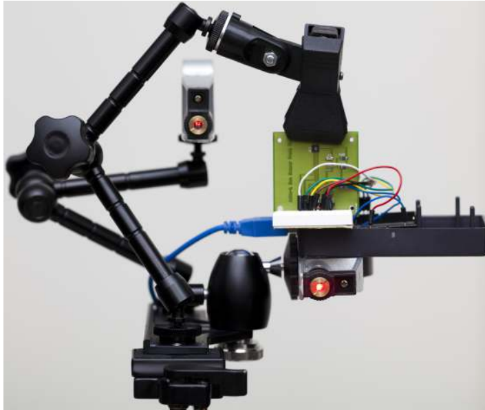
Figure 1 La Finlande lance son premier satellite en 2014. Nous avons conçu et réalisé le prototype du capteur solaire avec un Arduino
