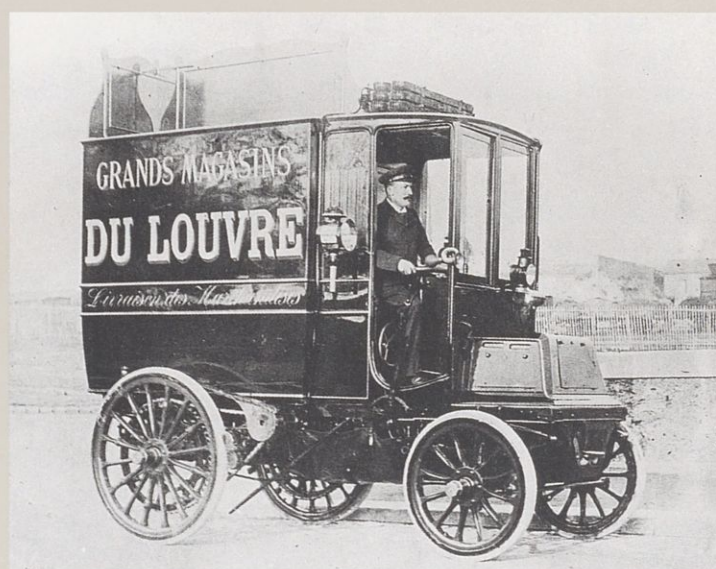
1898. Voiture de livraison Panhard et Levassor. Le conducteur est protégé des intempéries par un pare-brise, ce qui, sur un utilitaire, est une sorte de nouveauté. On remarquera le radiateur fixé sur le toit et la mécanique vaguement protégée par un tablier de cuir.
