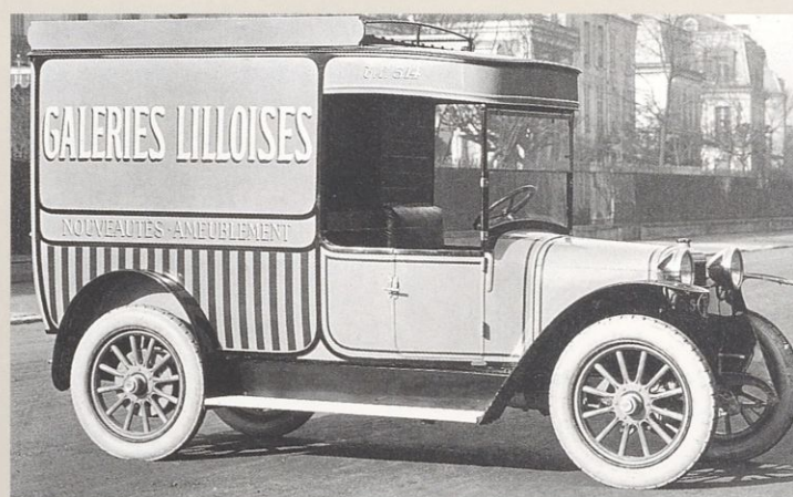
1922. Galeries Lilloises. Camionnette de livraison Panhard et Levassor, châssis SK4D avec des pneus Michelin Câblé 820 x 120.
