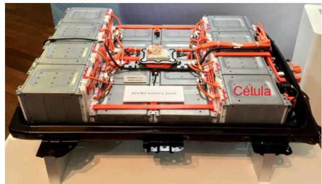
Figura 2.15 Bateria de íons de lítio com destaque das células. Fonte: WWW-Rede Mundial de Computadores.
