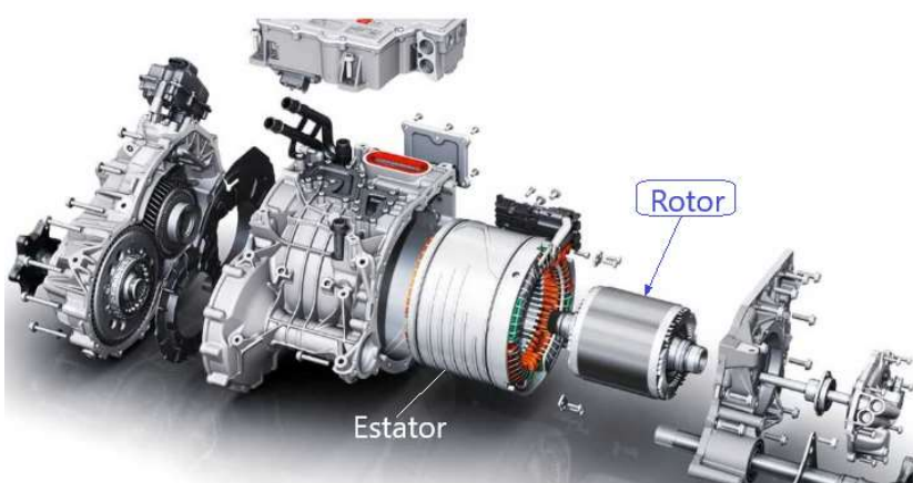
Figura 2.2 Componentes do sistema de um Veículo elétrico à bateria (BEV), com destaque para o rotor do motor elétrico. Fonte: WWW-Rede Mundial de Computadores.
