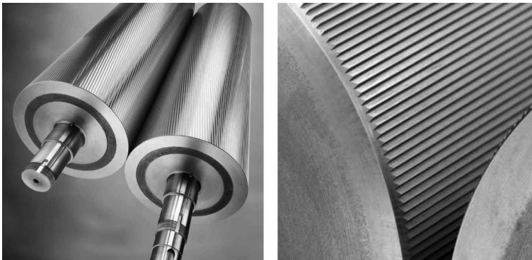
Figure 1.4 – Paire de cylindres cannelés (Source : Schneider Jaquet) et détail de la surface du cylindre (Crédits : GEA).
