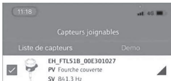
Figure 1.36 – Accès aux paramètres d'un capteur depuis l'application SmartBlue E&H .
