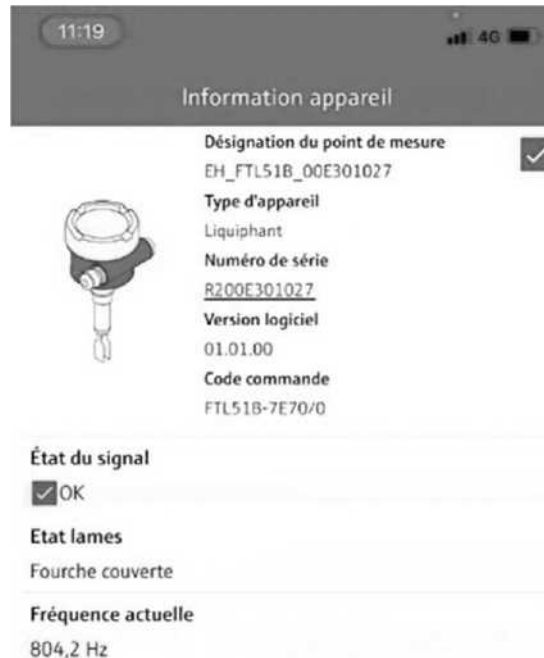
Figure 1.37 – Diagnostic d'un capteur de niveau depuis un smartphone à l'aide de l'application SmartBlue E&H .
