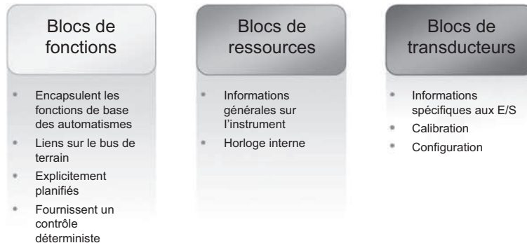
Figure 1.29 – Composition des blocs de fonction logiciel d'un capteur Fieldbus Foundation.
