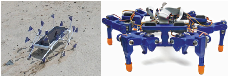
FIGURE 1.4. Robots marcheurs à 6 pattes développés au laboratoire de robotique de l'université Laval, voir [5] et [6].
