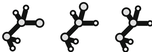
Figure 1.2 – Positions privilégiées de trois carbones successifs du PE.
